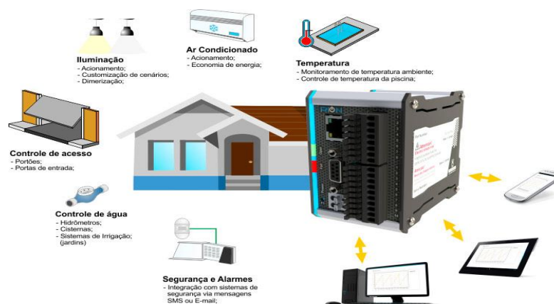
Figura 11: Sistema de automação predial HI
