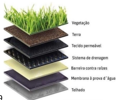
Figura 53: As camadas de um telhado Verde
