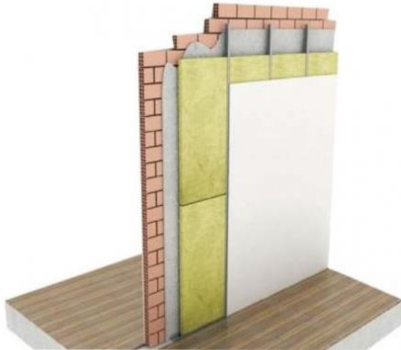
Figura 35 - Aplicação de lã de vidro.
