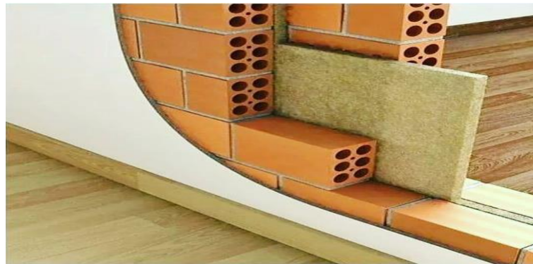
Figura 16: Esquema de parede dupla.
