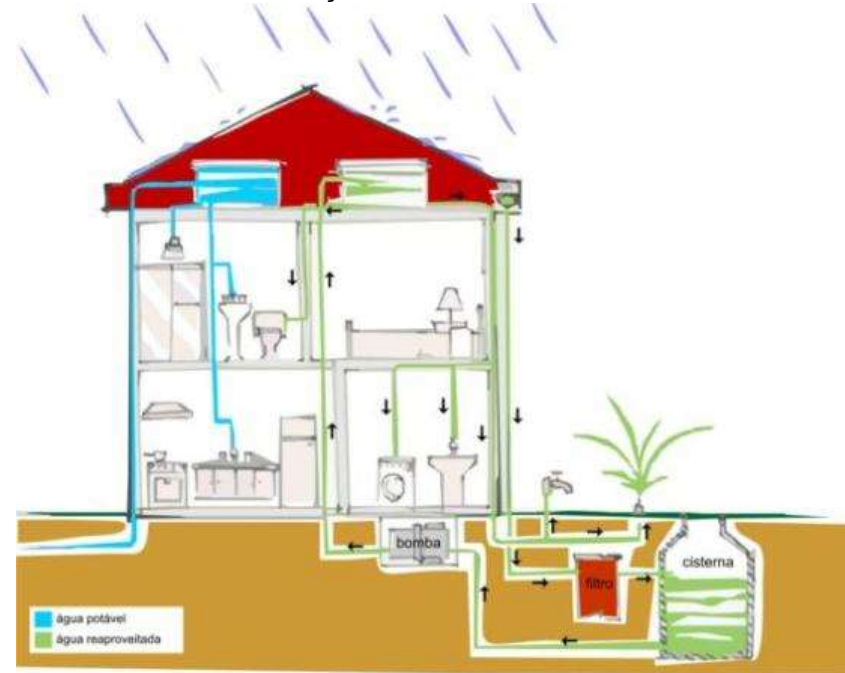
FIGURA 114: CAPTAÇÃO DE UMA CISTERNA NO SUBSOLO.
