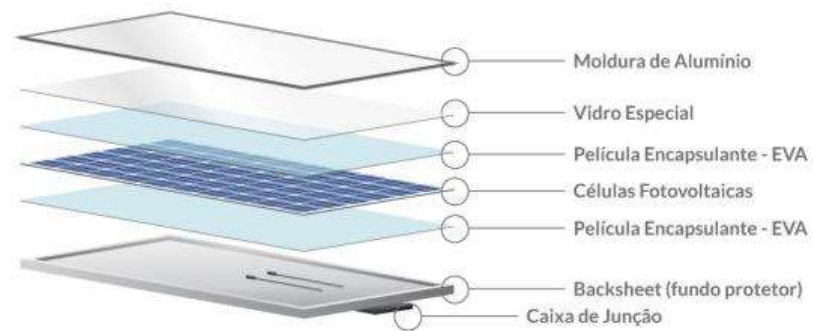
FIGURA 105: DETALHAMENTO PAINEL SOLAR.
