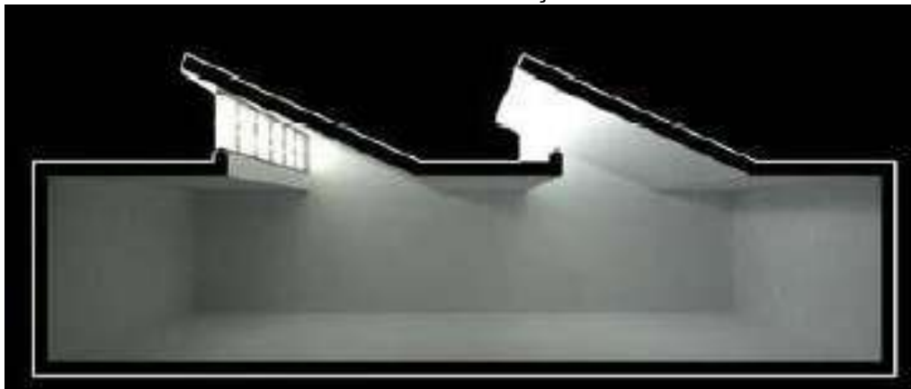
FIGURA 112: SHEDS ILUMINAÇÃO ZENITAL.
