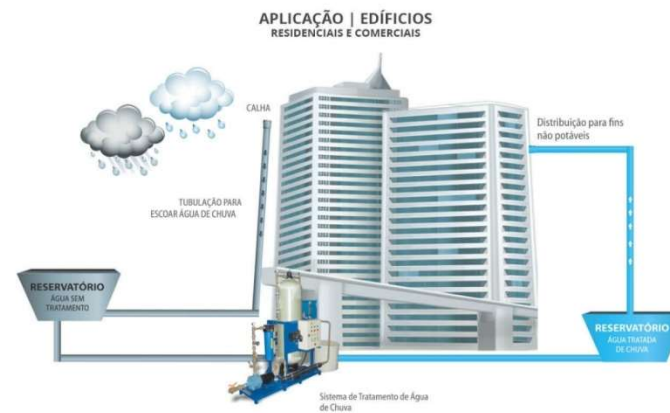
Figura 93: Sistema de captação de água da chuva
