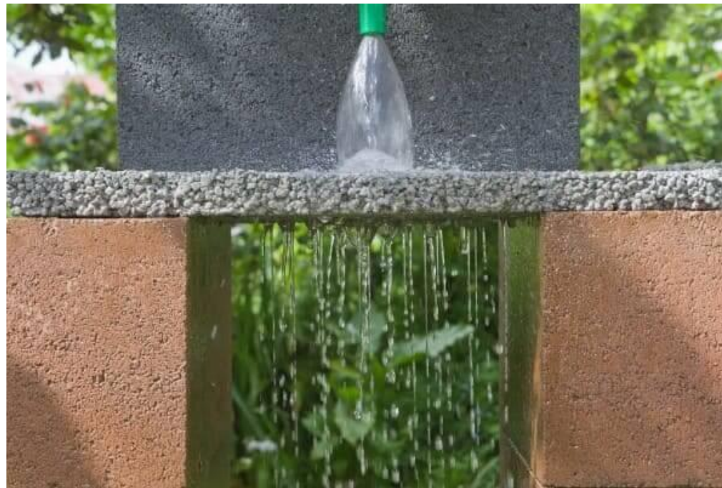
Figura 31 - Piso cimentício drenante
