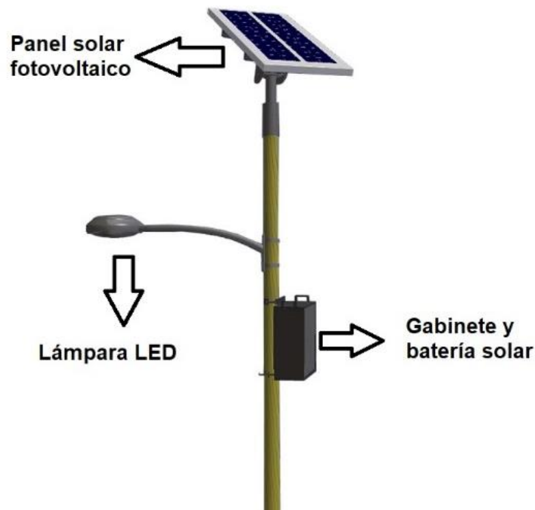
Figura 34 – Poste Solar funcionamento;
