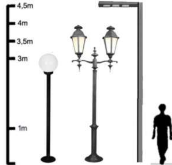
Figura 63: Dimensionamento Poste Colonial. Fonte: https://luminlandia.com (2021)
