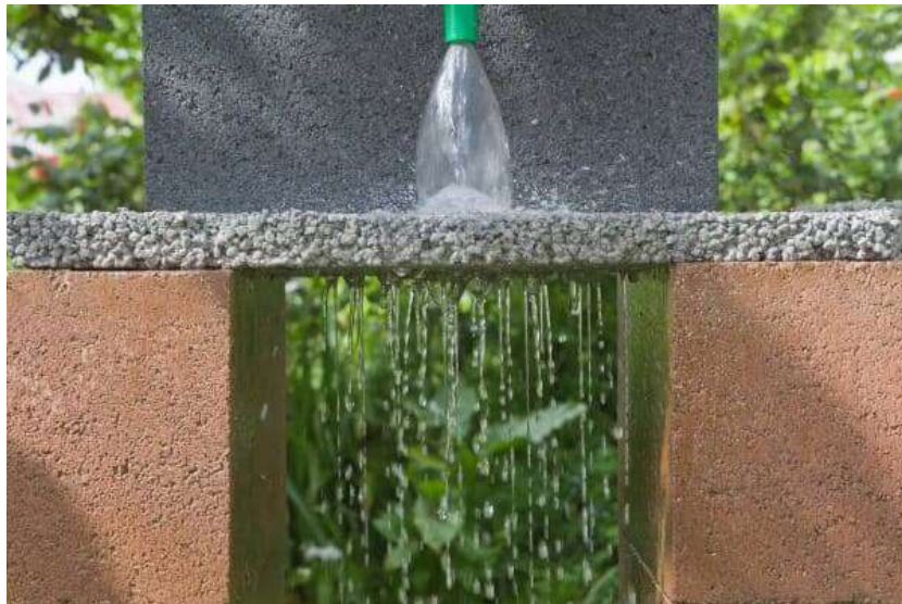
Figura 58: Demonstração de permeabilidade do piso drenante. Fonte: https://vivadecora.com (2021)
