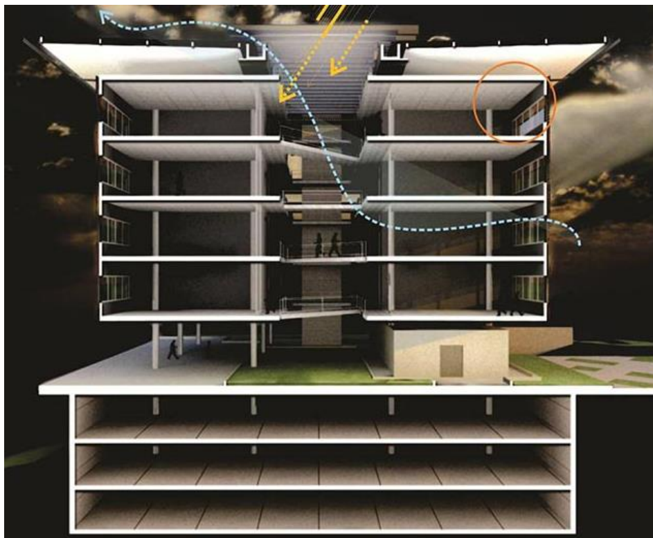
Figura 24 - Sistema de ventilação cruzada - Tecnocentro.
