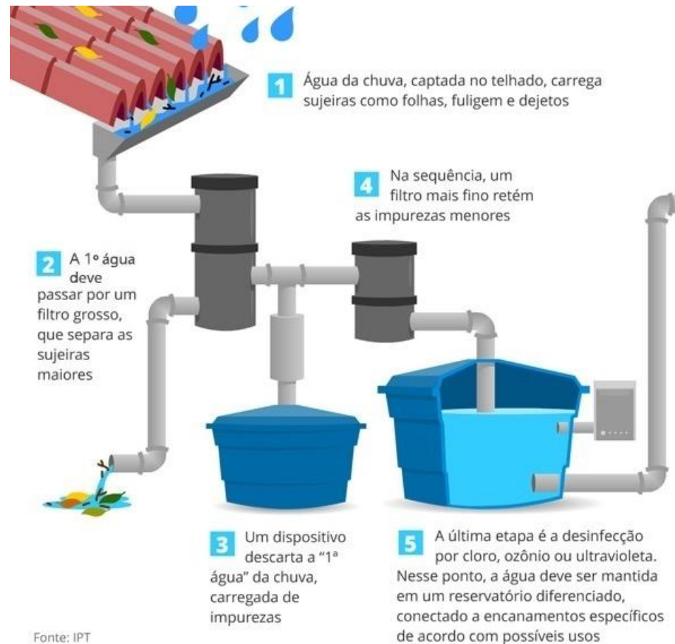
Figura 53 - Esquema captação de águas pluviais
