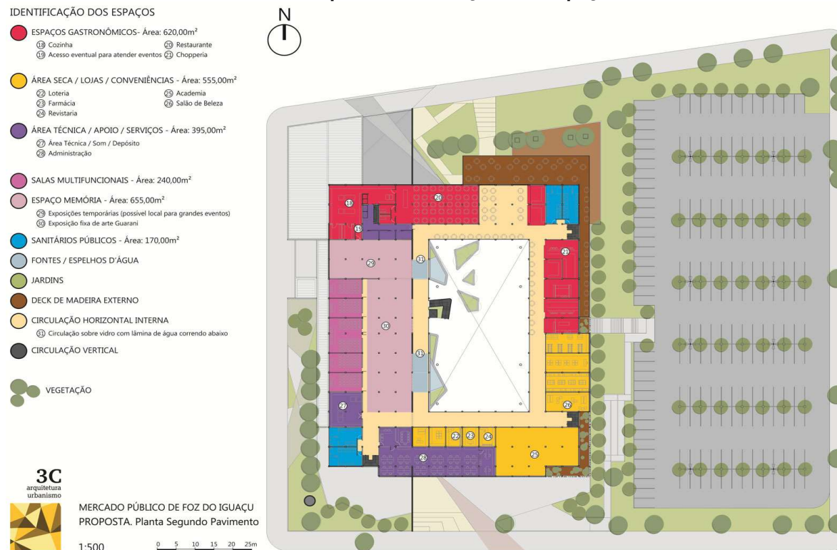
Figura 22: Planta Baixa 1º Pavimento- Mapa de identificação dos espaços do Mercado de Foz do Iguaçu
