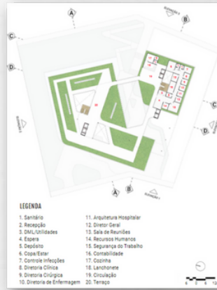
Figura 27: Planta Baixa Segundo Pavimento
