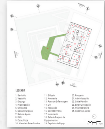
Figura 29: Planta Baixa Terceiro Pavimento
