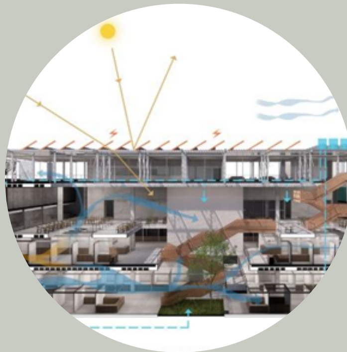
FIGURA 5: ESQUEMA DA BIOCLIMATIZAÇÃO
