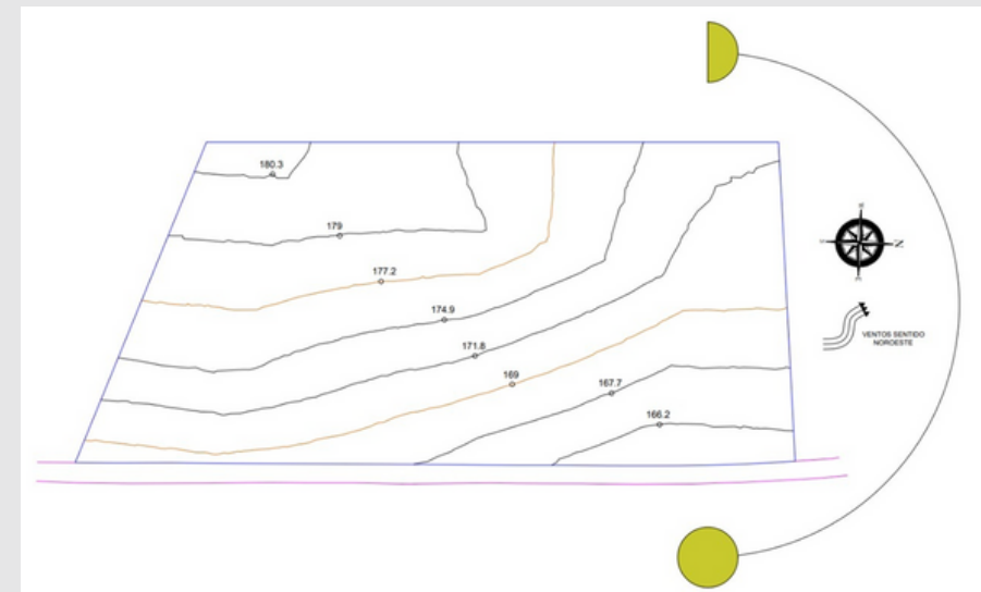
Figura 37 – Planta de orientação solar
