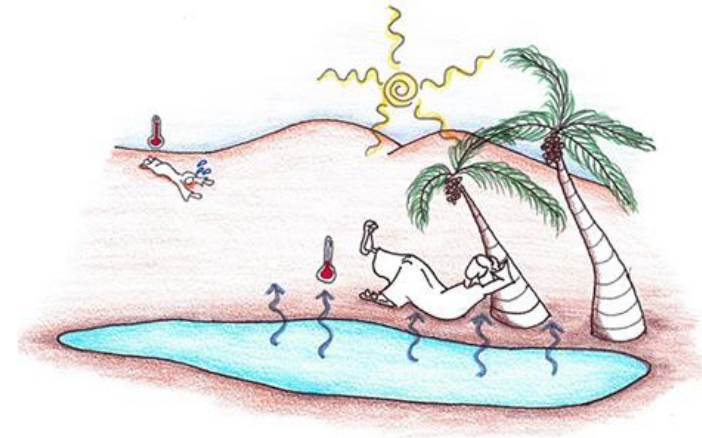
Figura 50: Esquema de resfriamento evaporativo passivo.
