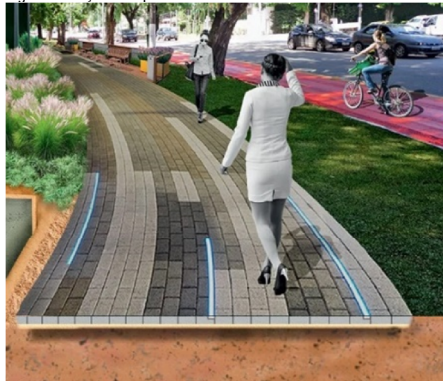
Figura 8 Calçada de piso drenante
