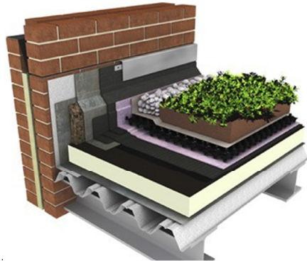
Figura 16 Telhado verde - esquema de montagem
