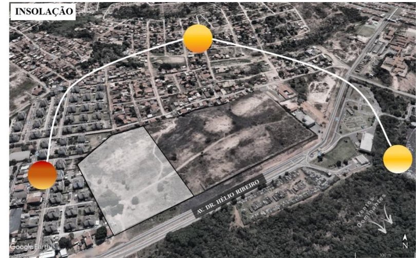
Figura 74 - Esquema com a insolação do terreno escolhido
