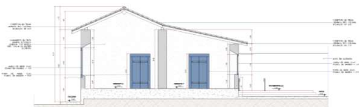
Figura 76 – Corte esquemático do casarão de Bem Bem. Fonte: Adaptado de GD Arquitetura, 2021.
