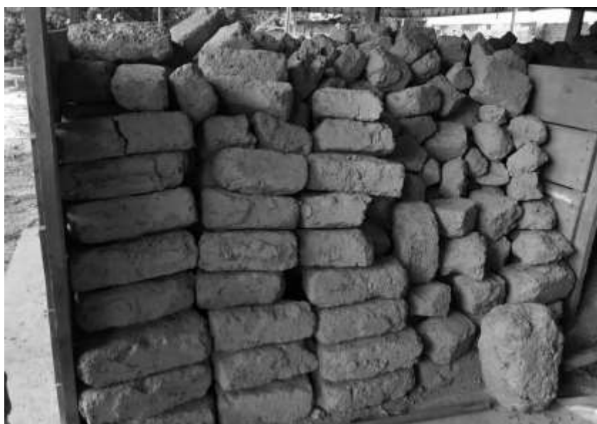
Figura 61 – Blocos de adobe armazenados pós desabamento da Casa de Bem Bem. Fonte: Próprio autor, 2020.
